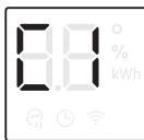
Ak je klimatizačné zariadenie vypnuté, automatické čistenie sa spustí hned. Ak je klimatizačné zariadenie spustené, automatické čistenie sa spustí hned ako sa klimatizačné zariadenie vypne.
